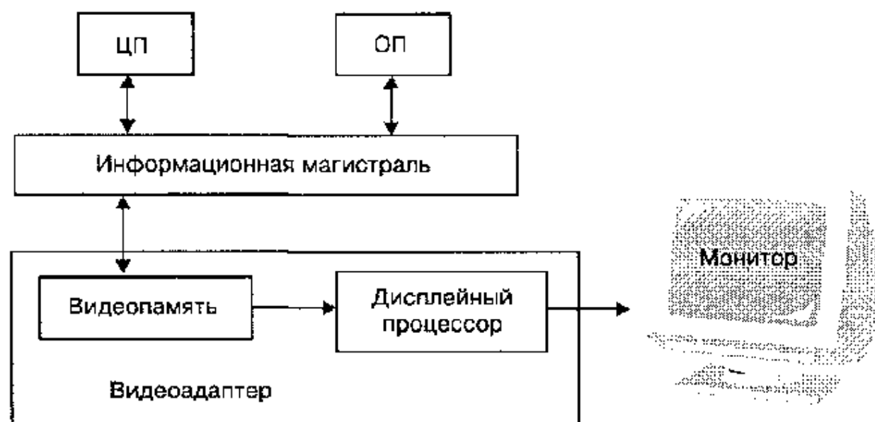
Рис. 4.7. Схема системы вывода изображения на экран.
